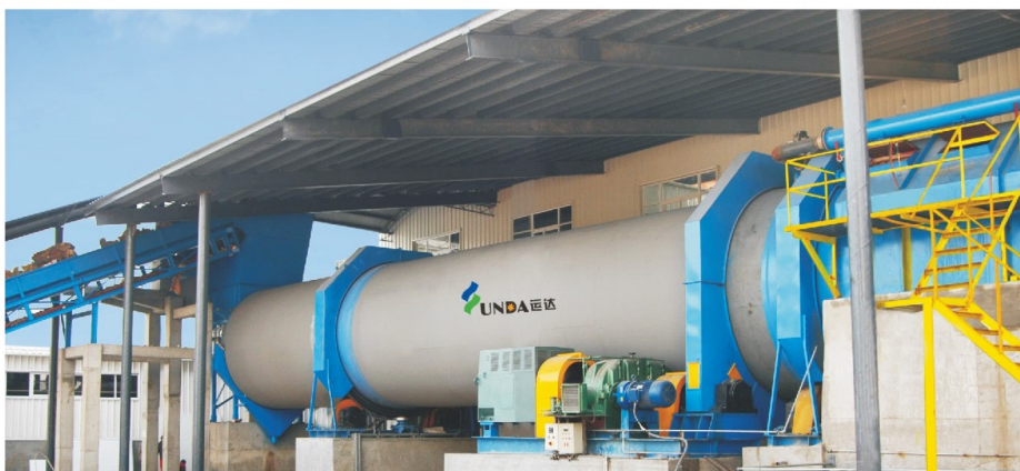
转鼓式碎浆机技术参数 Technical parameters
